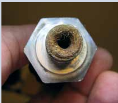
(Abb.3) Korrodiertes Druckschalter aus V4A aufgrund von Säurekorrosion in einem VE-Wasserkreislauf
