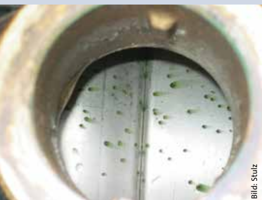
(Abb.5) Ansatz eines Biofilms durch bakterielle Korrosion an einer Pumpe, aufgrund der Verwendung von VE-Wasser ohne Zusätze
