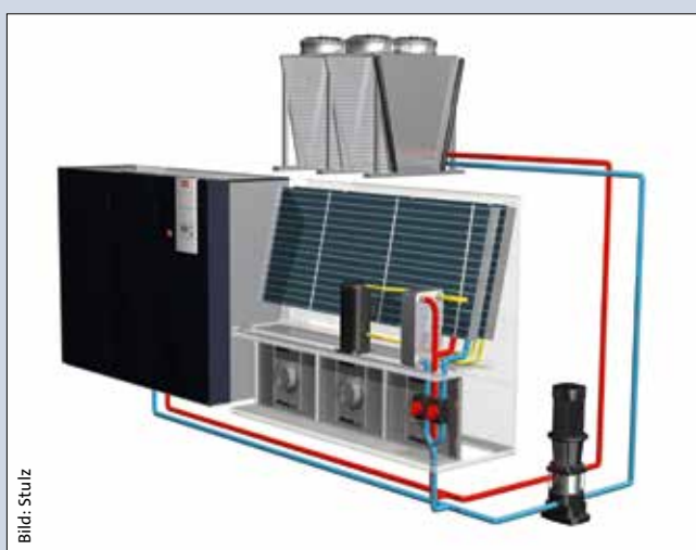
(Abb.1) In Rechenzentren kommen entweder Präzisionsklimageräte mit integriertem DX-Kältekreislauf...
