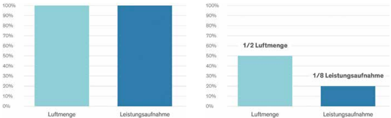
Abb.4: Standby-Management und Kubisches Gesetz
