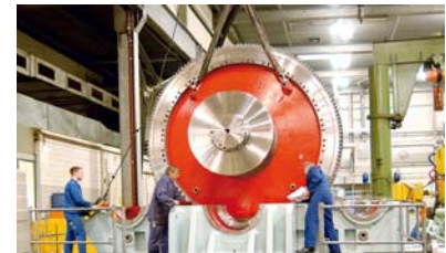
Montage eines Doppelschiffsgetriebes für Tanker
